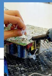
Operazioni di saldatura
