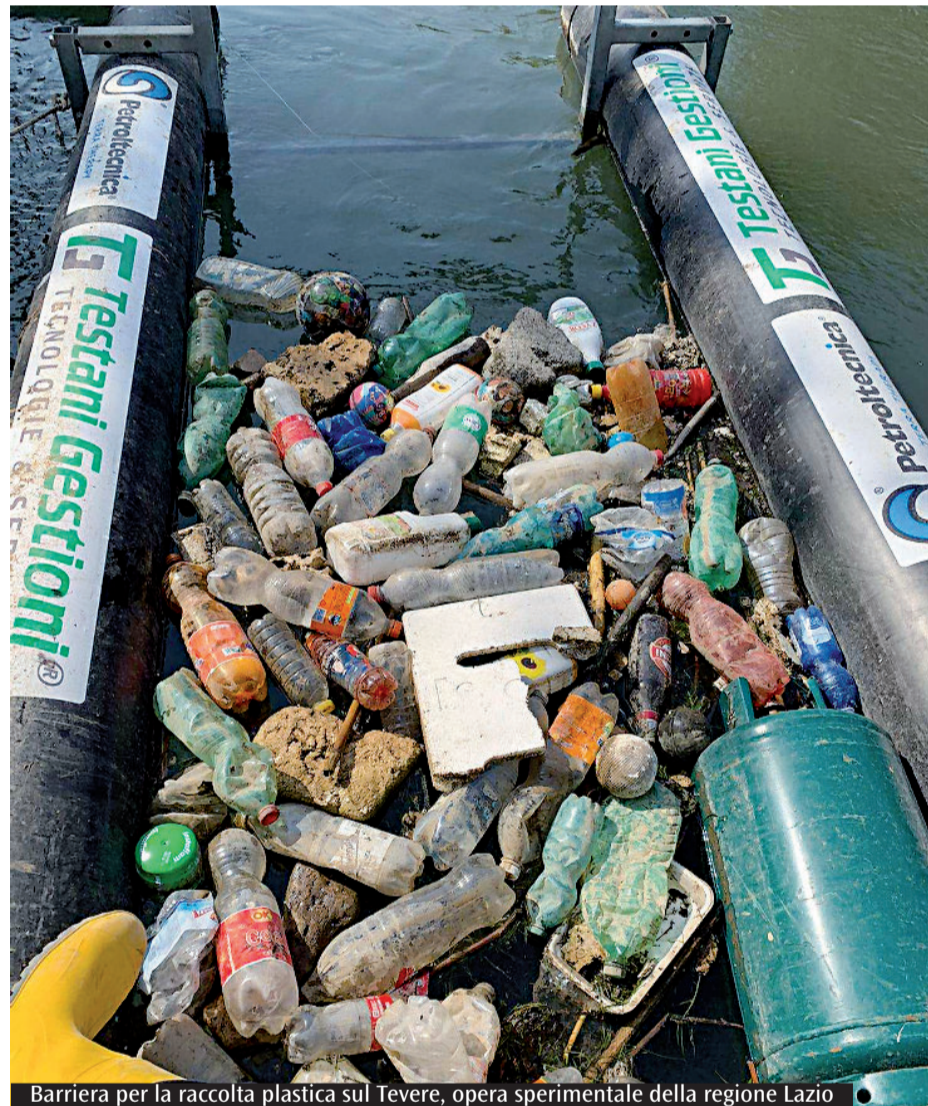
Barriera per la raccolta plastica sul Tevere, opera sperimentale della regione Lazio
